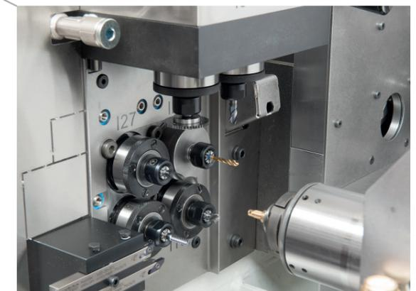
Pour l'usinage arrière et transversal, ce sont jusqu'à 6 broches (4 axiales et 2 verticales) qui peuvent être utilisées grâce à la flexibilité de l'axe Y. En complément aux broches, il est aussi possible d'installer jusqu'à 4 porte-outils de coupe.
